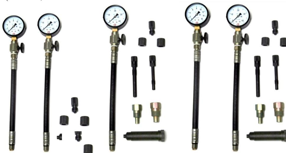
Рисунок 2 – Промышленные образцы компрессометров: а – BEST-01Б – бензиновый; б, в – дизельные: BEST-01Д с адаптером под фальшь-форсунки и BEST-02Д с набором адаптеров под форсунки и свечи накаливания (справа); г – BEST-01У – комплект для бензиновых и дизельных двигателей
